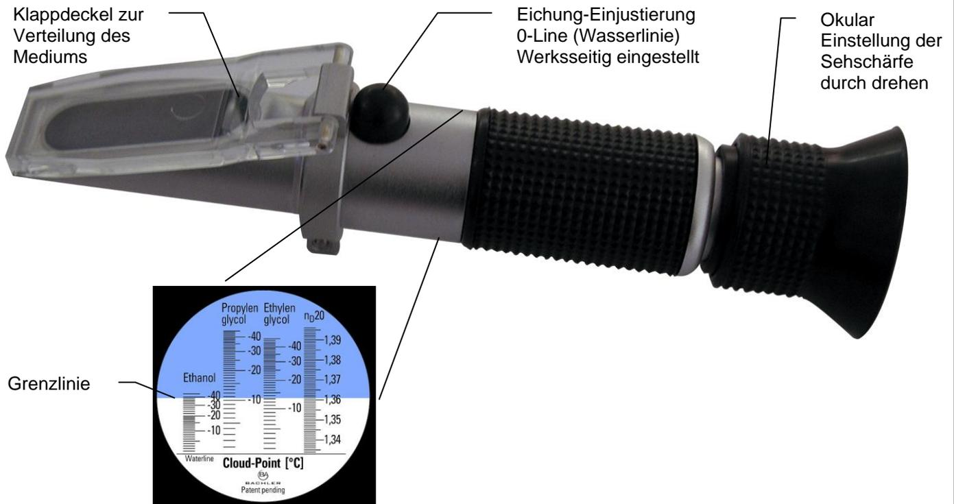
Das Handrefraktometer bestimmt den **Eisflockenpunkt (Cloud-point)** von Wasser-Propylenglykol-, Wasser- Ethylenglykol- und Wasser- Ethanolgemischen und den **n<sub>D</sub>20 Brechungsindex** von beliebigen Flüssigkeiten.
